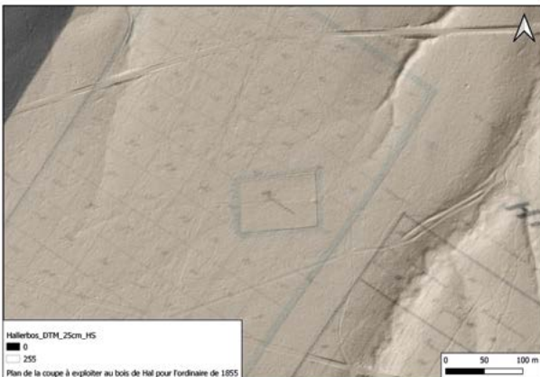
Gegeoreferentiekaart waarbij het oude kappingsplan als het ware bovenop een hillshade-verwerking van het digitale terreinmodel wordt gelegd.
